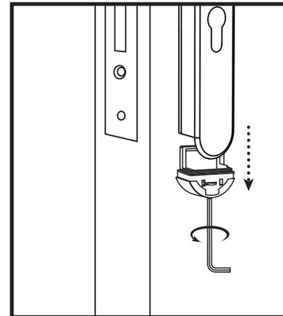
10 Utilisez un tournevis hexagonal (#1.5) pour tourner la vis au bas de la poignée extérieure dans le sens inverse des aiguilles d'une montre, puis retirez le support de pile.
