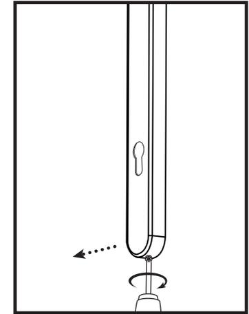
6 Tournez la vis au bas de l'ensemble de poignées intérieures dans le sens des aiguilles d'une montre (allez à l'intérieur) jusqu'à ce que de recouvrement puisse être retirée.
