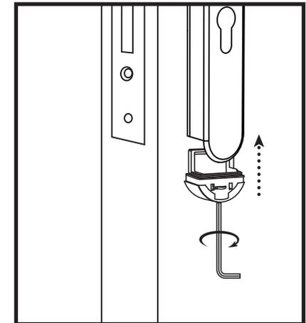
11 Après avoir repoussé le support de la batterie dans la poignée extérieure, utilisez un tournevis hexagonal (#1.5) pour serrer la vis dans le sens des aiguilles d'une montre.
