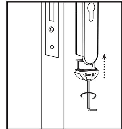
**11** Installeer de CR2-lithiumbatterij. Nadat u de batterijhouder terug in de buitenste handgreepset hebt geduwd, gebruikt u een zeskantschroevendraaier (nr. 1,5) om de schroef rechtsonder vast te draaien.
