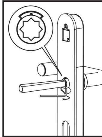
3 Installez la broche sur l'ensemble de poignée extérieure et utilisez un tournevis hexagonal (#1.5) pour serrer la broche.
