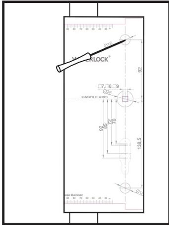
**1** Coloque la plantilla de perforación de la puerta sobre la puerta.
