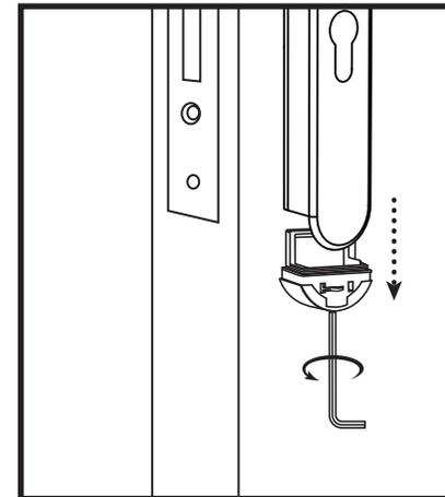
**10** Gebruik de inbussleutel (#1.5) om de schroef aan de onderkant van de buitenste handgreep tegen de klok in te draaien en trek vervolgens de batterijhouder eruit.
