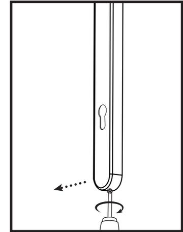
**6** Gire el tornillo al fondo del conjunto del pomo interior en dirección de las agujas del reloj (hacia adentro) hasta que la tapa pueda salir.
