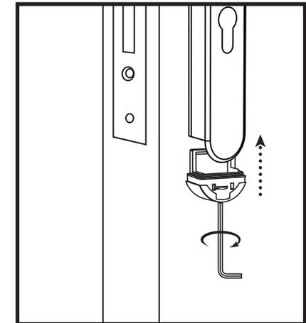
**11** Instale la batería de litio CR2 e instale la tapa de la batería de vuelta al conjunto del pomo exterior.
