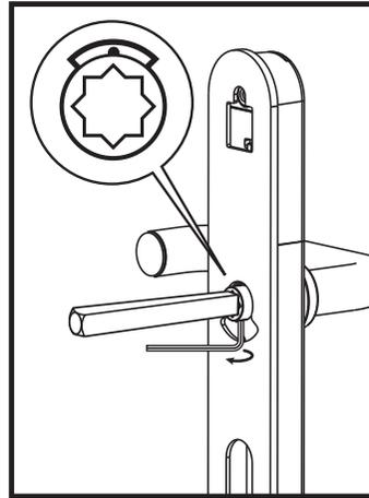
**3** Installeer de spindel op de buitenste handgreepset en gebruik de inbusschroevendraaier (nr. 1,5) om de spindel vast te draaien. Het schroefgat van de spindel moet aan de onderkant zitten en de markering van de koppeling moet aan de bovenkant zitten.
