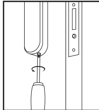
9 Tournez la vis au bas de la poignée intérieure réglée dans le sens inverse des aiguilles d'une montre (sortez) jusqu'à ce que vous sentiez une résistance.
