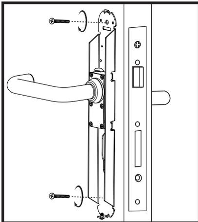
**7** Instale el conjunto del pomo interior en la puerta, y atornille el conjunto del pomo exterior e interior fuertemente.
