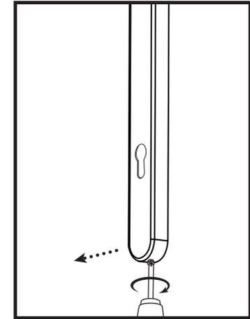
**6** Draai de schroef aan de onderkant van de set met de klok mee (naar binnen) tot de afdekplaat eruit kan worden getrokken. De binnenste handgreepset kan in de fabriek worden verwijderd. Wanneer de eerste keer installeert kun je deze stap overslaan.
