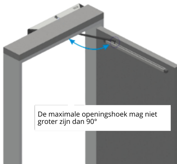
Installatie bij naar buitendraaiende deur
