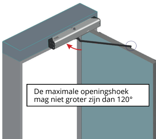
Installatie bij naar binnendraaiende deur
